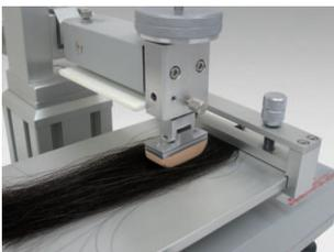
移動テーブルに毛束を設置して触覚接触子を用いて毛髪の方角によるすべりの評価を行った。毛根⇒毛先の測定波形は、非常に平滑であるが毛先⇒毛根の測定波形は、スティックスリップ現象が現れ、動摩擦係数、動摩擦領域での標準偏差値も高く示された。毛髪キューティクルの影響が示されている。
