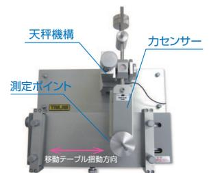
**天秤機構**：使用する接触子自重のウェイトバランスを取る事ができます。この状態で分銅を載せる事により分銅重量=測定垂直荷重となります。
