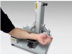
化粧品を塗布した前腕部に円板型接触子を下降させ2秒間加圧して、上昇させた際、肌表面と円板型接触子との間で発生するタック力を測定。
