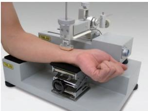
素肌、化粧水塗布直後、5分後での動摩擦係数の変化を時系列で測定した。動摩擦係数の変化と静摩擦係数の発生ポイントが異なってくる。これは、肌表面の状態による粘弾性挙動を示している。
